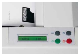
หน้าจอกำหนดการทำงาน มี 4 ปุ่มในการทำงาน พร้อมหน้าจอแสดงจำนวน
